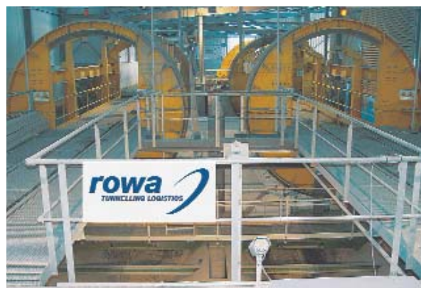
Mit der Rotationskippe Rowa Rotary III entleert der Lokführer einen Zug mit 150 Tonnen Ausbruchmaterial in weniger als zehn Minuten.
