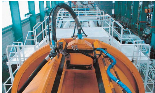
Spritzroboter für den TBM-Nachläufer der Firma Herrenknecht.
