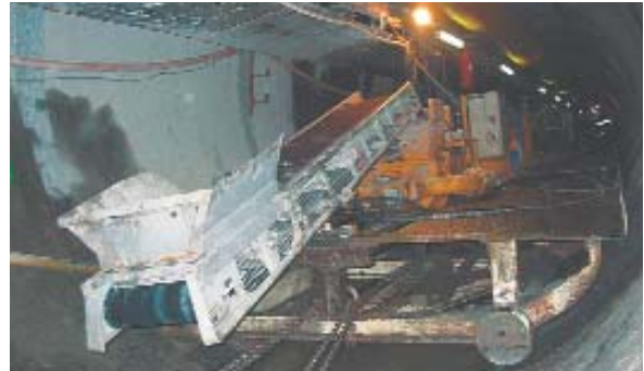
Nachläufer für eine Hartgestein-TBM mit kleinem Durchmesser.
